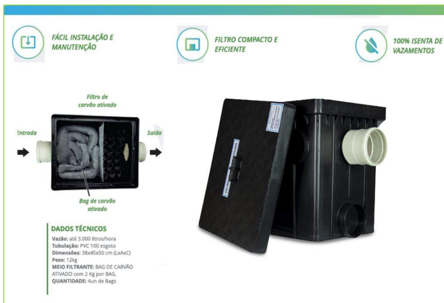
Figura 20: Especificações do filtro de carvão ativado adquirido. Fonte: Puro Diesel.
